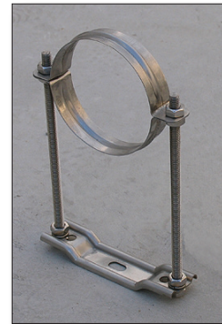
Többféle méretű, magasságban állítható, korrózióálló, bilincses lábelemek biztosítják a rácsszerkezet rögzítését, utat engedve a horizontális hőtágulási mozgásoknak.
