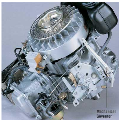
16. ábra: Napjaink centrifugál (röpsúlyos) szabályozója dízel üzemű belsőégésű motorban
